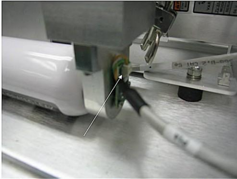
Abbildung B-42 Verkabelung am Kalibrierungsleck
