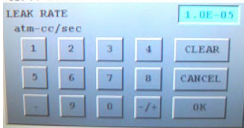
Abbildung 2-29 Tastenfeld für die Leckrate
