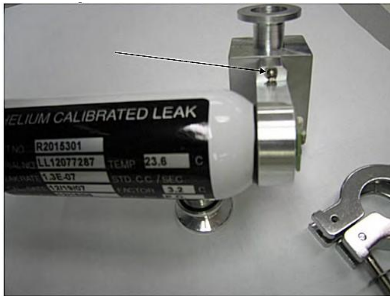
Abbildung B-44 Schrauben Kalibrierungsleck
