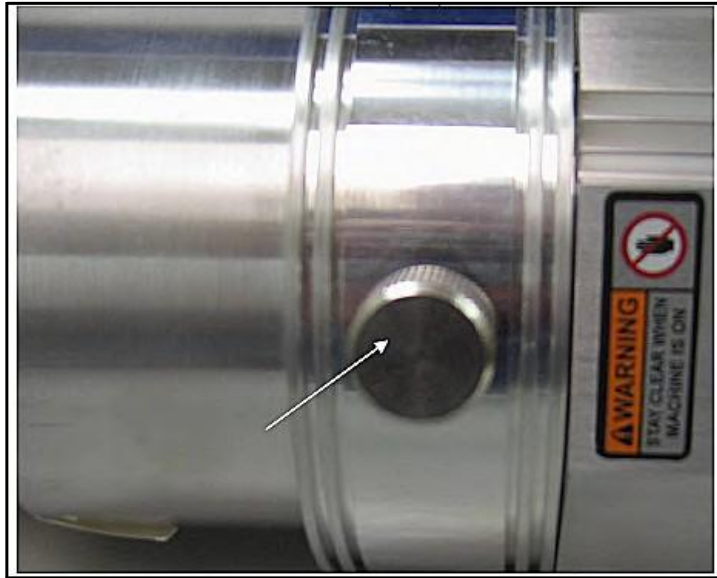
Abbildung B-2 NW25 Klemme mit Kalibrierungsleck nicht vorhanden
