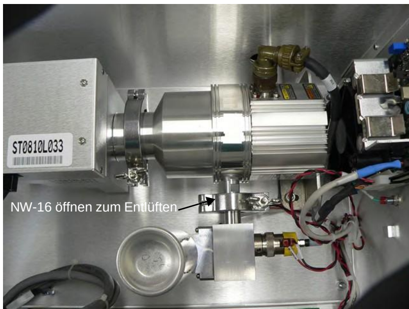
Abbildung B-59 Entlüftung des NW-16
